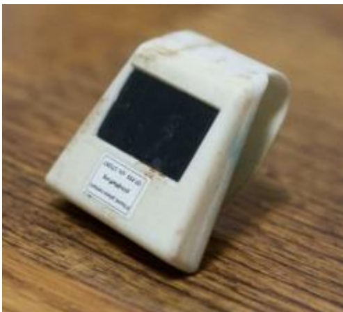
Εικόνα. II.2.5: Πομπός GPS/GSM φτερούγας και τοποθέτησή του με πλακίδιο Wing-tag. Φωτ: Hristo Peshev / FWFF)
