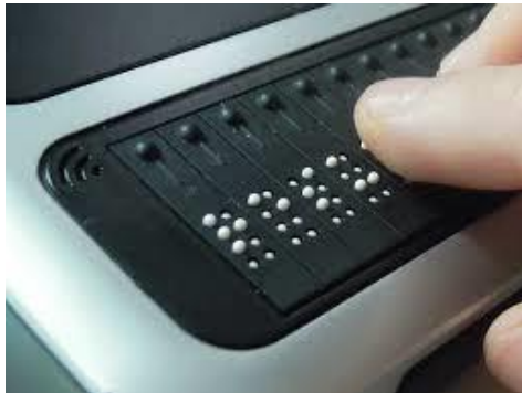
Εικόνα 4-6: Στην εικόνα φαίνεται το τερματικό μιας πινακίδας μπράιγ (braille display)
