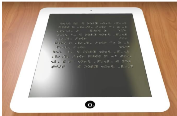
Εικόνα 4-8: Απτική ανάγνωση σε tablet με τη χρήση ενός refreshable braille display που ανέπτυξαν ερευνητές στο Πανεπιστήμιο του Michigan
