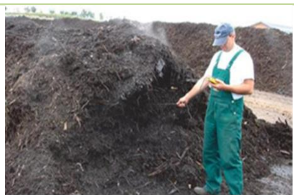
Μέτρηση θερμοκρασίας / υγρασίας σειραδίων
